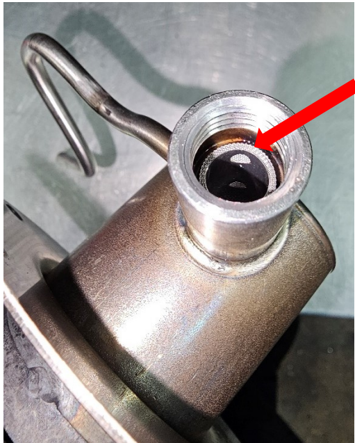
Abbildung 4: Glühkerzenschirm in Brennkammer
